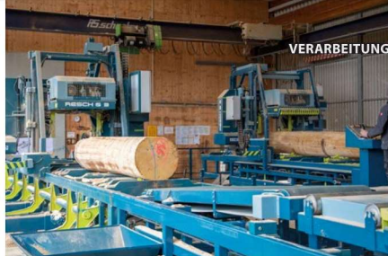
Die bestehende ES 1050 Profi (li.) ist auf Stammelängen von 14 m ausgelegt, während es bei der neuen 8 m sind
